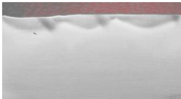
Рис. 2. Макрошлиф поперечного сечения закаленного слоя (глубина проплавления 2.7 мм)
